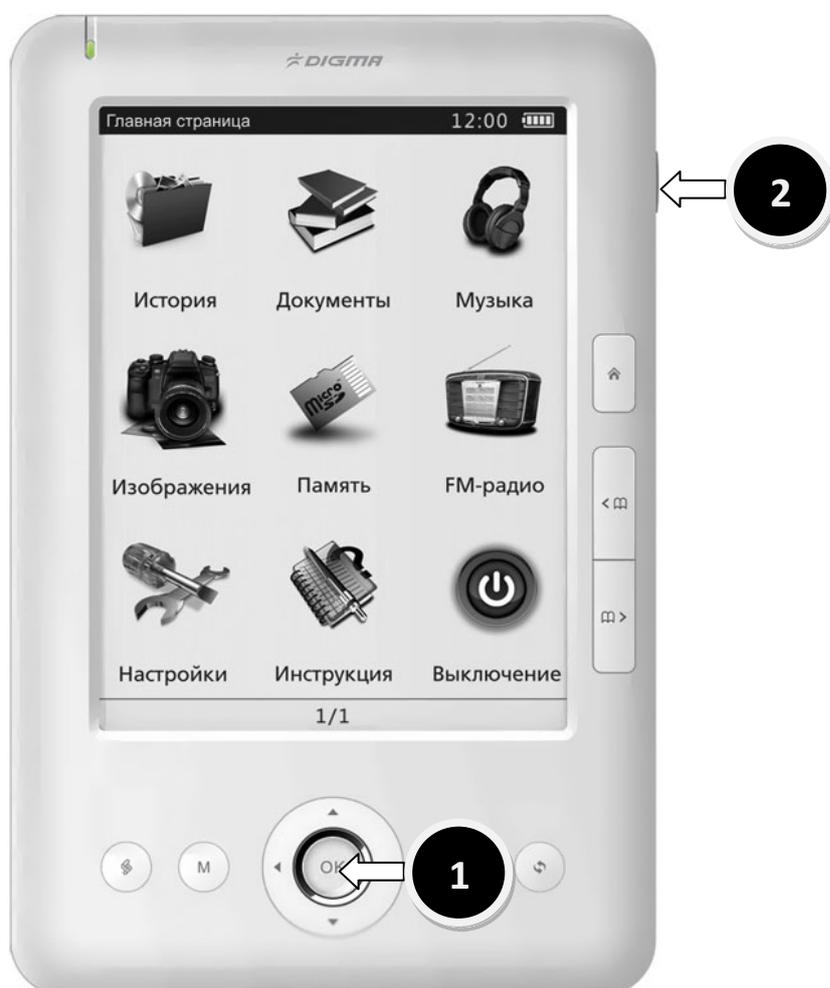
Дождитесь пока мигнет экран. Спустя 1-2 секунды отпустите кнопку питания (2), затем спустя 2-3 секунды отпустите кнопку Ввод (1). Дождитесь обновления прошивки.
