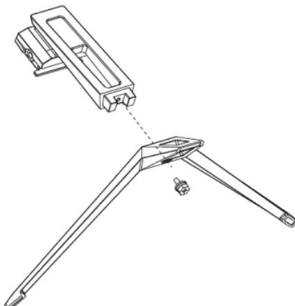
2. Положите устройство на ткань экраном вниз, чтобы предотвратить повреждение экрана. Установите собранный корпус подставки в пазы задней части устройства до характерного щелчка.
