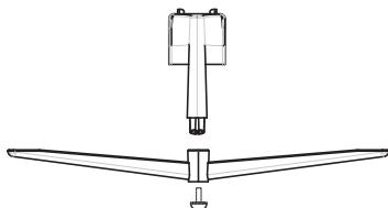
2. Положите монитор на ткань ЖК-панелью вниз, чтобы предотвратить повреждение ЖК-панели. Прикрепите корпус подставки к задней части монитора.
