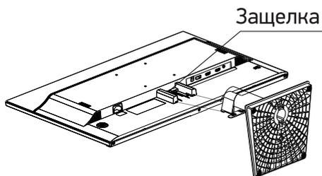
3. Установите собранный корпус подставки в пазы задней части монитора до характерного щелчка.
