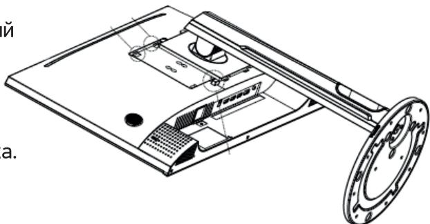
3. Установите собранный корпус подставки в пазы задней части монитора до характерного щелчка.
