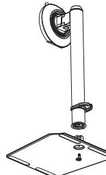
2. Положите монитор на ткань ЖК-панелью вниз, чтобы предотвратить повреждение ЖК-панели. Установите собранный корпус подставки в пазы задней части монитора до характерного щелчка.
