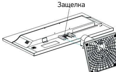
3. Установите собранный корпус подставки в пазы задней части монитора до характерного щелчка.
