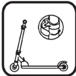
2. Сложите рукоятки, опустите рычаг складывания и установите рулевую стойку в горизонтальное положение.
