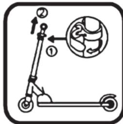
2. Установите руль на нужную высоту и затяните зажим, чтобы зафиксировать рулевую стойку. Установите рукоятки горизонтально, убедитесь, что пружинные кнопки на рукоятках попали в пазы рулевой стойки.
