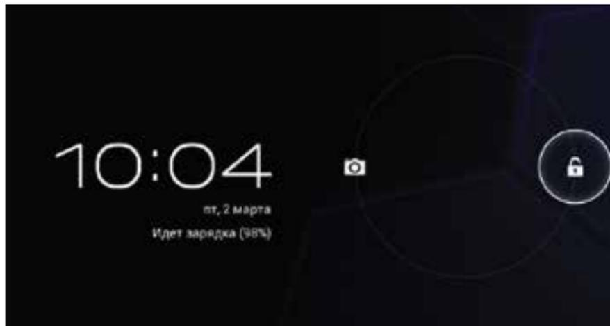
**Режим ожидания:** В рабочем режиме короткое нажатие на кнопку включения питания переведет устройство в режим ожидания, экран погаснет. Новое короткое нажатие на кнопку питания выведет устройство из этого режима, на дисплее появится экран блокировки. Проведите процесс разблокировки.
