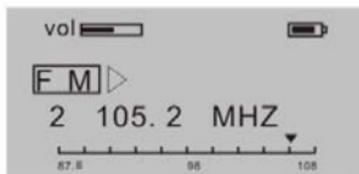
В режиме FM нажмите **MODE**, затем с помощью **◀◀** и **▶▶** выберите частоту FM, каждое нажатие кнопки увеличивает или уменьшает частоту на 0.1МГц. Выбрав нужный FM канал, нажмите **MODE** для входа в режим настроек. Нажмите кнопку **MODE** еще раз, чтобы войти в режим сохранения канала в памяти устройства. Нажмите **MODE**, а затем **▶▶**, чтобы устройство
