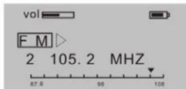
В режиме FM нажмите **MODE**, затем с помощью **[◀]** и **[▶]** выберите частоту FM, каждое нажатие кнопки увеличивает или уменьшает частоту на 0.1МГц. Выбрав нужный FM канал, нажмите **MODE** для входа в режим настроек. Нажмите кнопку **MODE** еще раз, чтобы войти в режим сохранения канала в памяти устройства. Нажмите **MODE**, а затем **[▶]**, чтобы устройство
