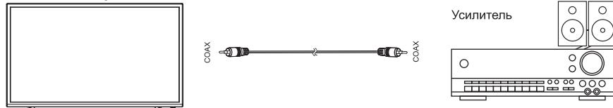
Только для ЦТВ или HDMI источника сигнала. Подключите коаксиальный вход внешней аудиосистемы к соответствующему выходу телевизора. Коаксиальный выход телевизора обеспечит вам наиболее качественную передачу звука на внешнюю аудиосистему без искажений.
