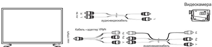
Подключите видеокамеру к телевизору, используя кабель-адаптер YPbPr (для видео) и аудио кабель 2xRCA «тюльпан» (кабель-адаптер mini YPbPr 3,5mm - YPbPr и аудио 2xRCA «тюльпан» в комплект поставки не входят).
