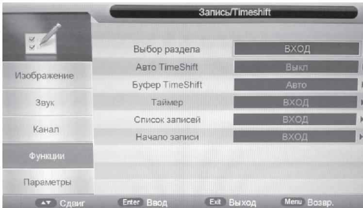
Прежде, чем записывать цифровой телеканал на USB носитель или пользоваться функцией отложенного просмотра, настройте USB носитель для правильной работы в этих режимах. Меню Запись/TimeShift (PVR/TimeShift) выглядит следующим образом.
