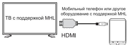
Подключение HDMI (MHL) предназначено для подключения к телевизору смартфона и просмотра на телевизоре фотографий и видео прямо со смартфона.
