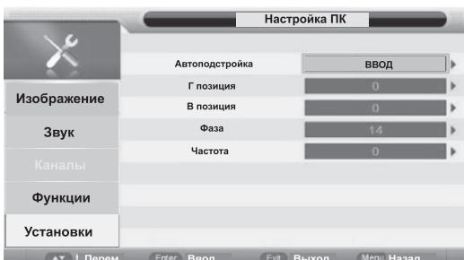
Настройте телевизор, чтобы использовать его как монитор при подключении к компьютеру по VGA кабелю.
