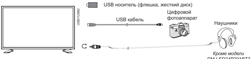
Разъем для подключения USB-устройства телевизора становится активным только в режиме USB.
