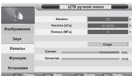
С помощью кнопки ENTER/[▶] выберите номер канала, либо введите номер канала при помощи цифровых кнопок . Затем с помощью ENTER/[▶] выберите параметр «START» для начала поиска выбранного вами канала.
