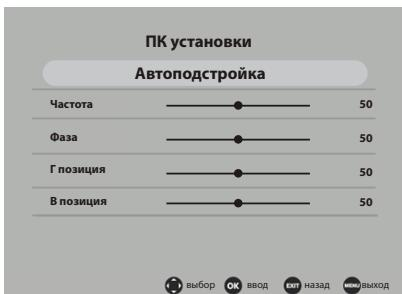
Настройте телевизор, чтобы использовать его как монитор при подключении к компьютеру по VGA кабелю.
