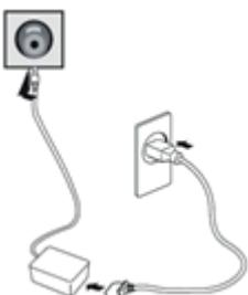
Подключите прилагаемый кабель питания к разъему питания, а затем подключите другой конец к розетке.
