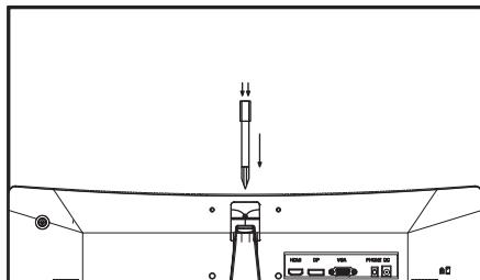
2. Прикрепите основание подставки к корпусу подставки, затянув винт.
