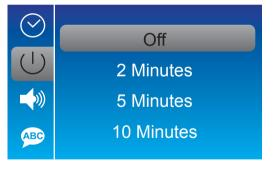
**Автовыключение (Auto Power Off):** Настройка «Автовыключение» позволяет настроить задержку автоматического отключения, активируемого после пропадания внешнего питания, в случае если не нажато ни каких кнопок.
