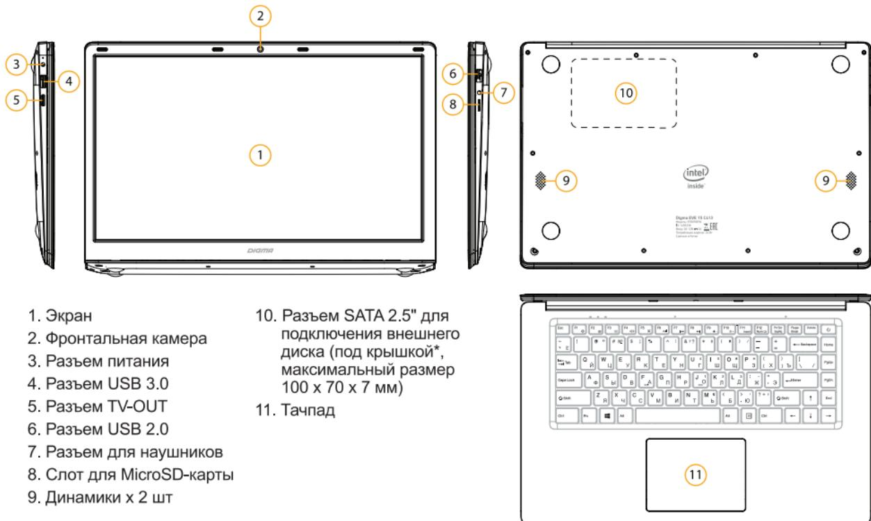
\*Для подключения внешнего диска необходимо полностью снять нижнюю крышку ноутбука.
