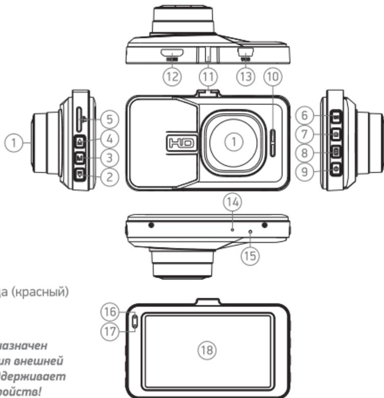
**\*ВНИМАНИЕ! Разъём (12) предназначен исключительно для подключения внешней камеры регистратора и не поддерживает подключение других HDMI-устройств!**
