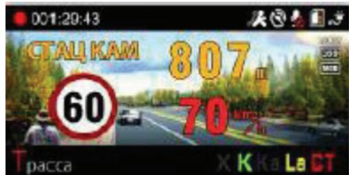
В том случае, если скорость автомобиля превышает установленный на этом участке дороги предел, прибор сообщает об этом звуковым сигналом и окрашивает значение скорости автомобиля, указанную на дисплее в красный цвет. При определении комплексов: “Переезд”, “СТР-ВБ” и “Дор-Фин” звукового оповещения не будет, т.к. они не определяют скорость автомобиля.
