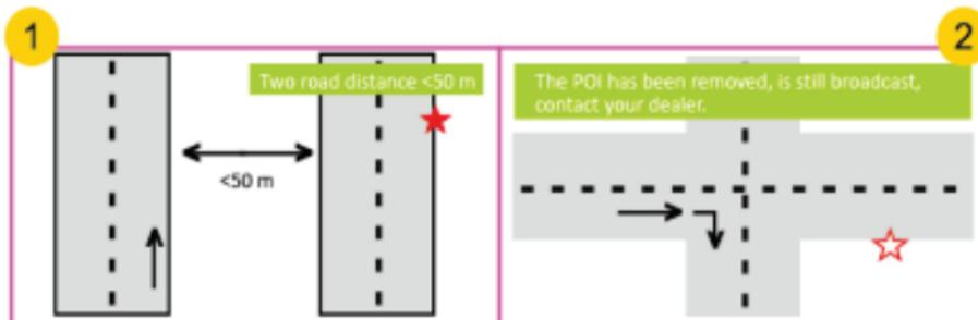
1. Расстояние между двумя параллельными дорогами  $<50\text{м}$ . Может произойти ошибочное оповещение.
