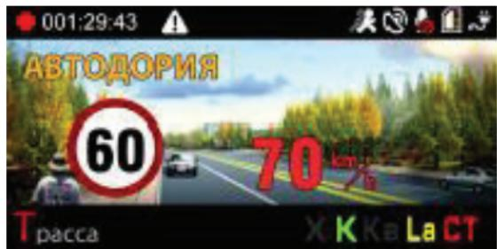
Как только Прибор определяет начало дистанции действия комплекса “Автодория”, прибор начинает автоматически вычислять среднюю скорость движения автомобиля. Если эта величина превысит установленный на данном участке предел, Вы услышите звуковое предупреждение о превышении скорости. Значение скорости автомобиля на дисплее прибора также окрасится в красный цвет.
