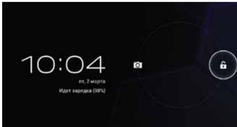
**Режим ожидания:** В рабочем режиме короткое нажатие на кнопку включения питания переведет устройство в режим ожидания, экран погаснет. Новое короткое нажатие на кнопку питания выведет устройство из этого режима, на дисплее появится экран блокировки. Проведите процесс разблокировки.
