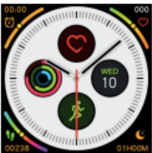
**Циферблат** – устройство имеет десять циферблотов. Чтобы изменить циферблат, длительно нажмите на экран (3 сек.), отображающий текущее время.
