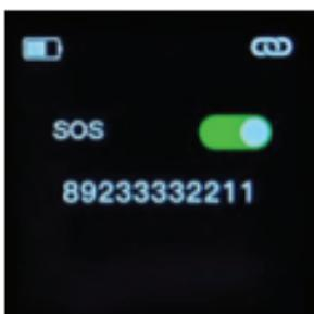
**SOS** – для включения данной функции, необходимо перевести триггер в правое, крайнее положение. Ввести любой номер телефона для экстренного вызова и нажать ОК для сохранения. При следующем, долгом нажатии боковой кнопки (1) будет автоматический произведен вызов с часов на сохраненный номер телефона.
