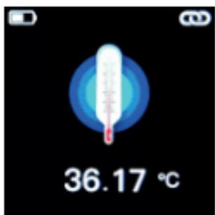
**Термометр** – часы оснащены встроенным термодатчиком, расположенным на задней стороне устройства. Для максимально точного измерения температуры тела необходимо как можно плотнее застегнуть ремешок часов и через 5-10 минут произвести измерение.
