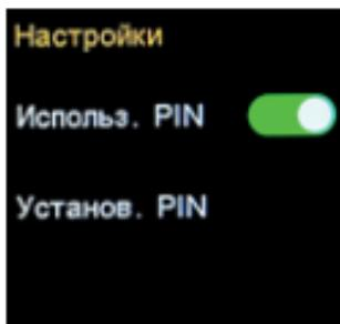
**PIN-код** – для включения данной функции, необходимо перевести триггер в правое, крайнее положение, нажать «Установ. PIN», далее дважды ввести PIN-код и нажать OK. При следующем включении экрана в верхней части часов отобразится иконка замка и при попытке выполнить любое действие устройство запросит PIN-код.
