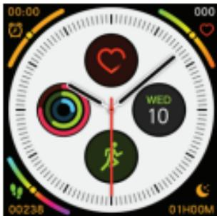
**Циферблат** – устройство имеет шесть циферблотов и один пользовательский. Чтобы изменить циферблат, длительно нажмите на экран (3 сек.), отображающий текущее время. Пользовательский циферблат доступен через приложение V Band и позволяет выбрать любое изображение с Вашего смартфона в качестве обоев.
